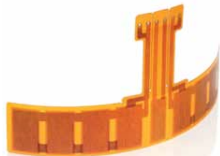
Einlamierte Keramikschichten in einer DuraAct Wandleranordnung (Array)
