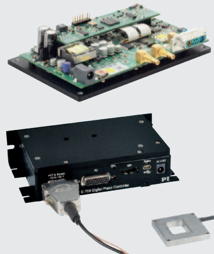
Dieselbe Technik steckt im E-609 Piezocontroller und im E-709 Digitalcontroller. Im E-609 verwendet PI einen digitalen Regler in einem rein analog anzusteuernenden Gerät. Der E-709 bietet zusätzlich die Kommandierung über SPI, USB und RS-232 Schnittstellen.
