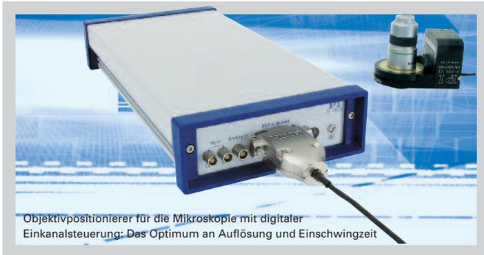
Objektivpositionierer für die Mikroskopie mit digitaler Einkanalsteuerung. Das Optimum an Auflösung und Einschwingzeit
