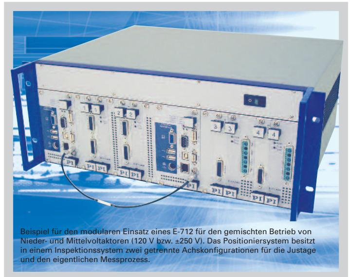
Beispiel für den modularen Einsatz eines E-712 für den gemischten Betrieb von Nieder- und Mittelvoltaktoren (120 V bzw. ±250 V). Das Positioniersystem besitzt in einem Inspektionssystem zwei getrennte Achskonfigurationen für die Justage und den eigentlichen Messprozess.
