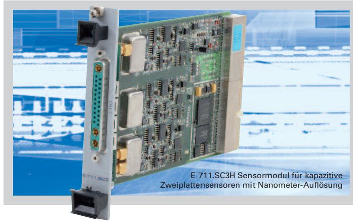
E-711.SC3H Sensormodul für kapazitive Zweielektroden-Sensoren mit Nanometer-Auflösung
