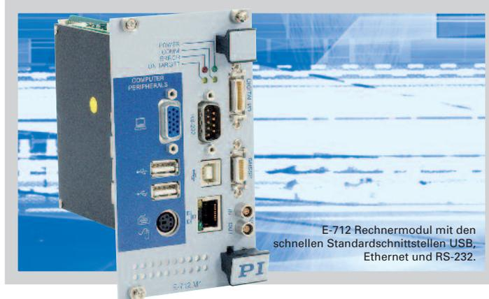
E-712 Rechnermodul mit den schnellen Standardschnittstellen USB, Ethernet und RS-232.
