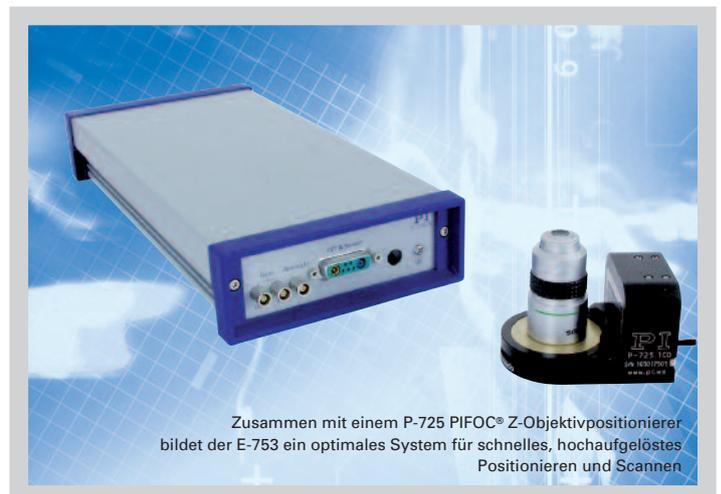
Zusammen mit einem P-725 PIFOC® Z-Objektivpositionierer bildet der E-753 ein optimales System für schnelles, hochaufgelöstes Positionieren und Scannen
